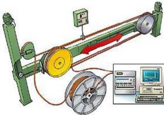
**Figura 15.- Ejecución de la prueba según EN 187000 Método 501.**
