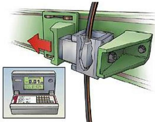
**Figura 17.- Ejecución de la prueba según EN 187000 Método 504.**
