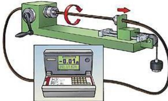
**Figura 20.- Ejecución de la prueba según EN 187000 Método 508.**
