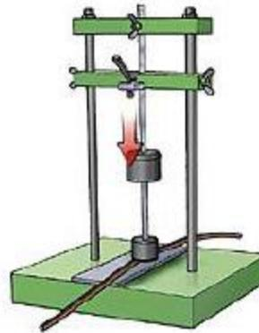
Figura 19.- Ejecución de la prueba según EN 187000 Método 505.
