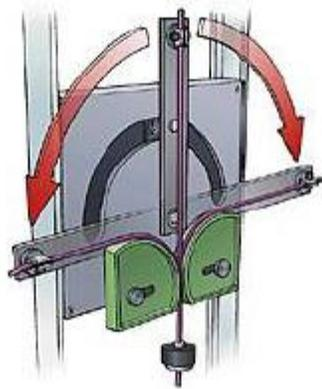
Figura 16.- Ejecución de la prueba según EN 187000 Método 507.
