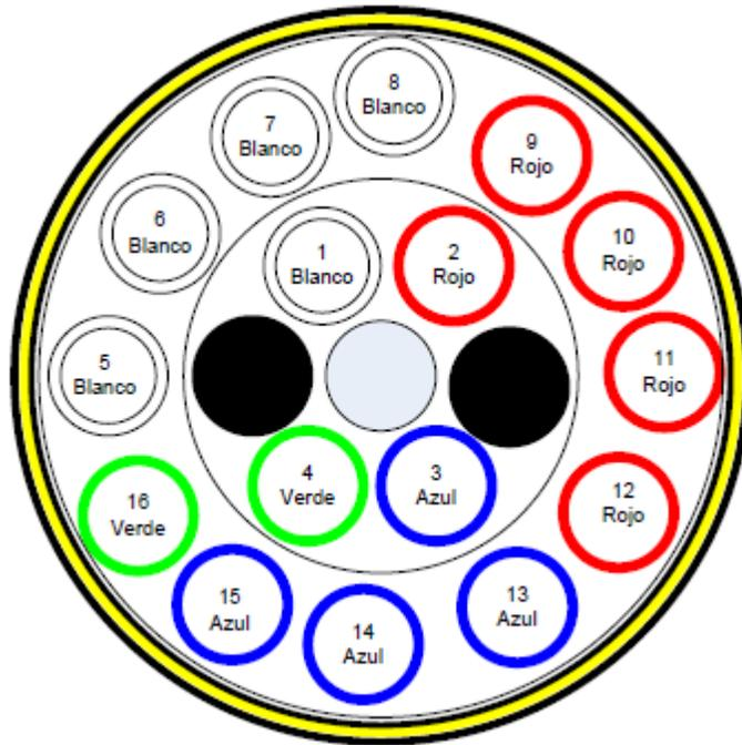
Figura 8.- Código de colores tubos del cable de 128 fibras (112xG.652 D + 16xG.655C)
