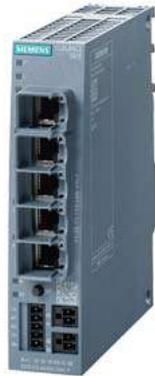
SCALANCE S615 LAN-Router; para proteger dispositivos/redes en automatización y para asegurar la comunicación industrial vía VPN y firewall; otras funciones: conversión de direcciones (NAT/NAPT), conexión a SINEMA RC, 5 puertos switch, 1 entrada digital, 1 salida digital
