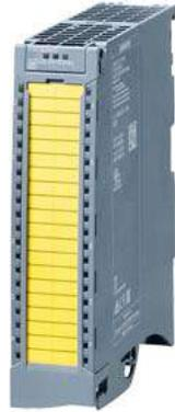
SIMATIC S7-1500, módulo de salidas digitales de seguridad, F-DQ 8 x 24 V DC 2 A PPM PROFIsafe; ancho 35 mm; hasta PL e (ISO 13849-1)/ SIL3 (IEC 61508)
