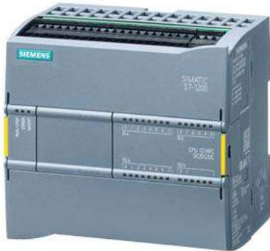
SIMATIC S7-1200F, CPU 1214 FC, CPU compacta, DC/DC/DC, E/S integradas: 14 DI 24 V DC; 10 DO 24 V DC; 2 AI 0-10 V DC, alimentación: DC 20,4-28,8 V DC, memoria de programas/datos 200 kB
